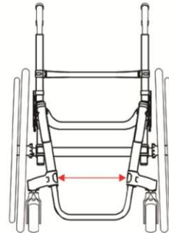
Note : Une hauteur sol siège de plus de 50.8cm réduit la largeur de l'appui-pieds de 2.5 cm avec une section fuselée de 5 cm
